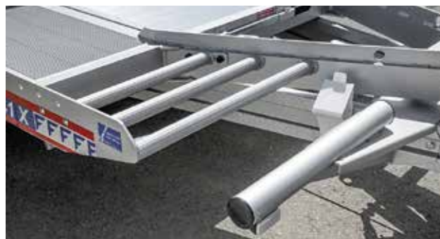
OPV-plateau: Overrijdblok voor de opname van de overrijdplaten van een Blitzlader.
