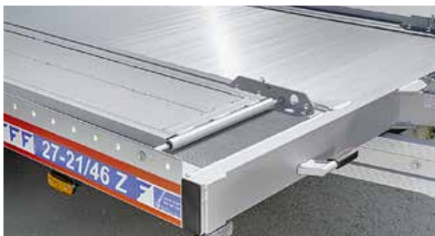
MPV-plateau: Overrijdinrichting met opklapbare rijplaten.
