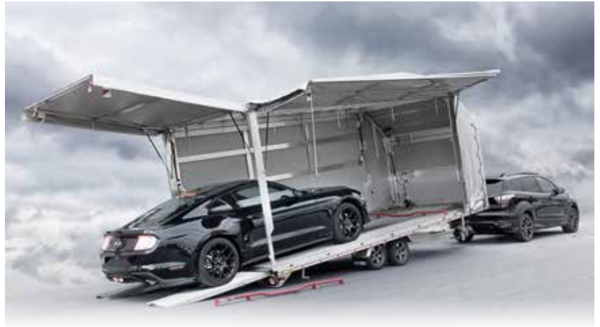
De opklapbare versie: scharnierende achterklep en zijkleppen met gasdrukveren.
