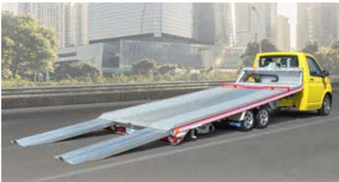
Der SPEEDER 2 ist ein leichtes und wendiges Fahrzeug für den professionellen Fahrzeugtransport. Geringes Eigengewicht, hohe Nutzlasten und eine lange Lebensdauer zeichnen den SPEEDER 2 aus. Das neu entwickelte Fahrgestell mit Luftfederung und Scheibenbremsen ist leicht, modern und sicher.
