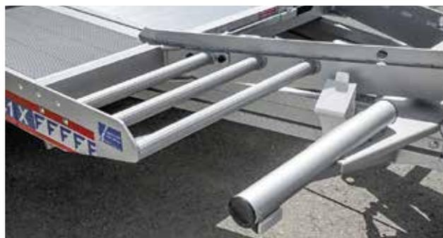
OPV-Plateau: Überfahrbock zur Aufnahme der Überfahr-Rampen eines Blitzladers.
