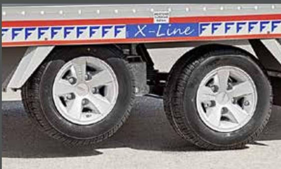
Die Liftachse macht das Rangieren per Hand einfacher und schont bei Leerfahrten die Reifen.
