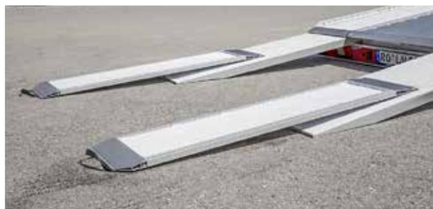
Zusatz-Ladeschienen ermöglichen einen noch flacheren Auffahrwinkel.
