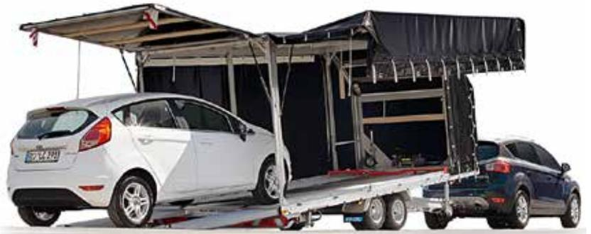
Die Klappversion: Ausstellbare Heckklappe und Seitenklappen mit Gasdruckfedern.
