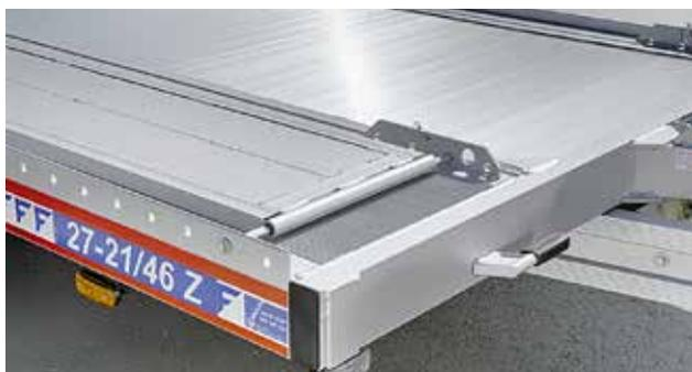
MPV-Plateau: Überfahreinrichtung mit klappbaren Ladeschienen.
